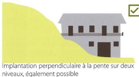
Implantation perpendiculaire à la pente sur deux niveaux, également possible
